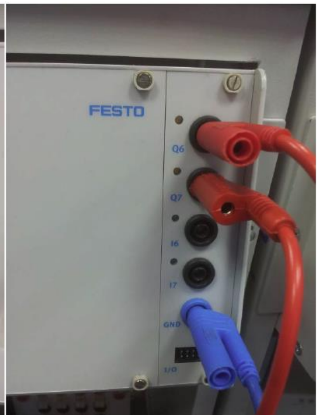
Подключение блока световой индикации к выходам панели управления станции распределения
