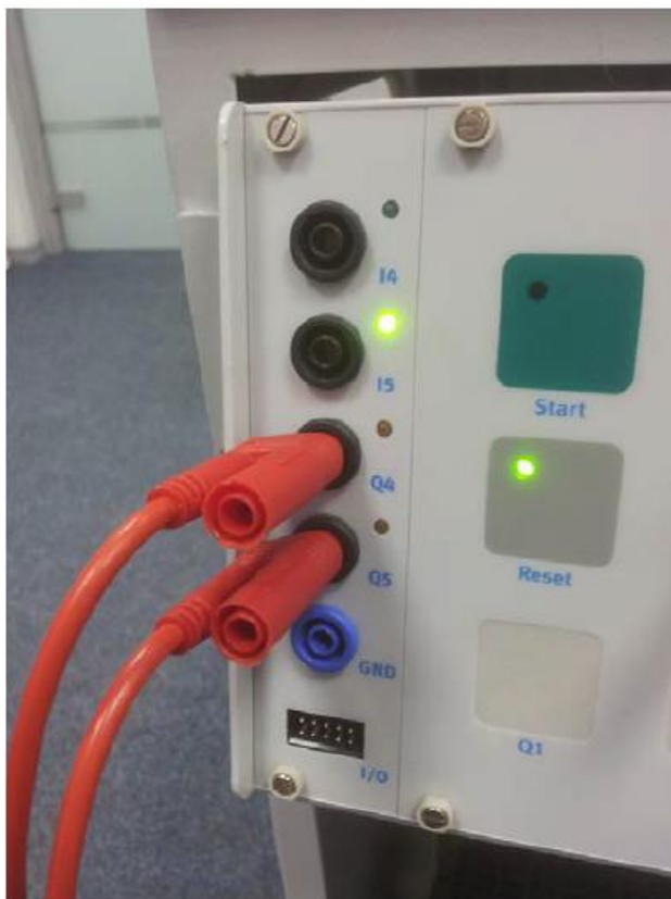
Подключение блока световой индикации к выходам панели управления станции распределения
